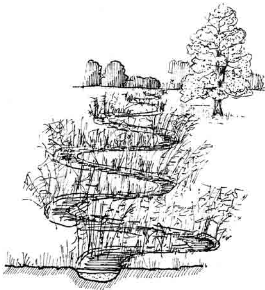
Malé, mělké koryto v ploché louce. Naznačené zvlnění je zřetelně nadměrné, neodpovídající přirozeným poměrům. Revitalizačnímu efektu díla to však nevedí. Toto koryto se brzy zanesou, voda stoupne, a to podpoří mokřadní vývoj louky.
